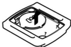
**Schritt 2:** Entfernen Sie weitere 4 Schrauben auf der Platine.
