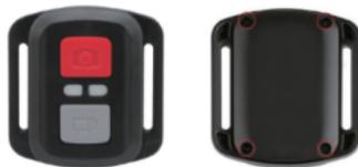
**2** Entfernen Sie weitere 4 Schrauben auf der Leiterplatte.
