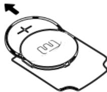
**Paso 3:** Levante la placa de circuito y deslice la batería como se muestra en la imagen.
